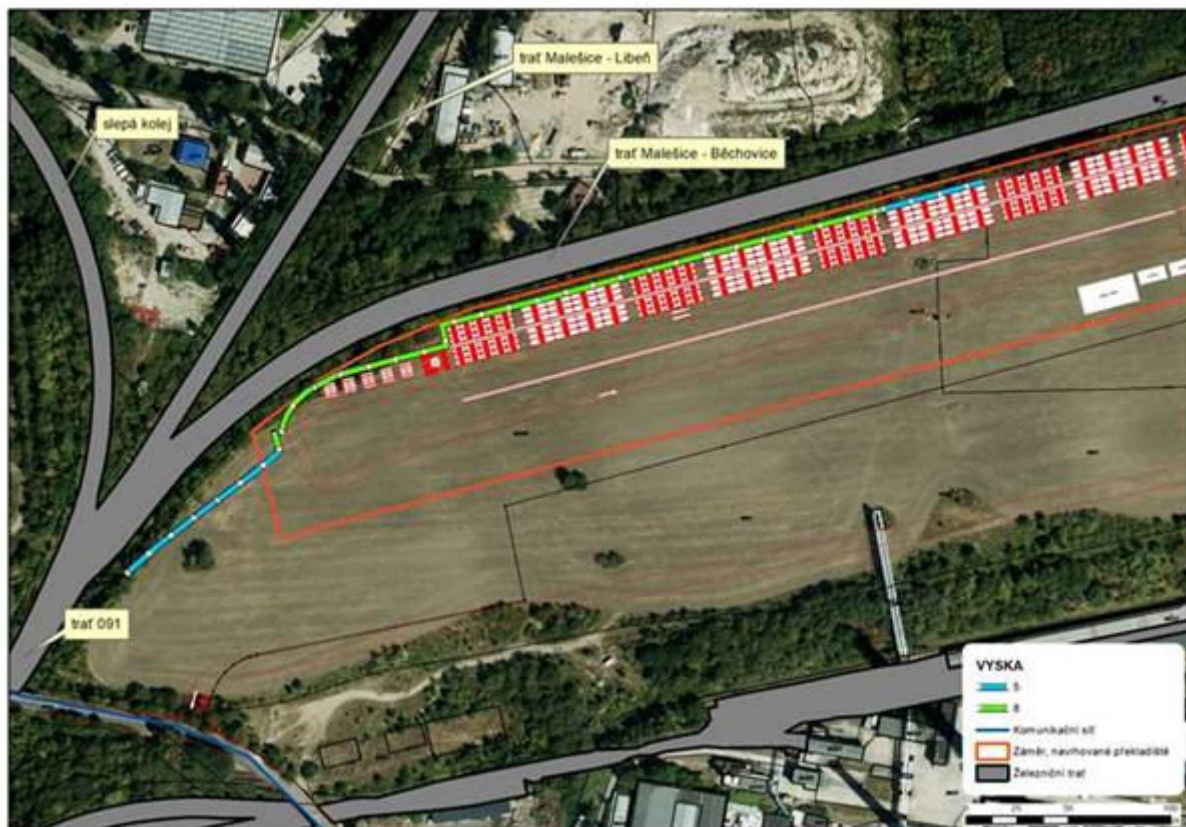
Obr.č. 1 Navržené protihlukové stěny.
