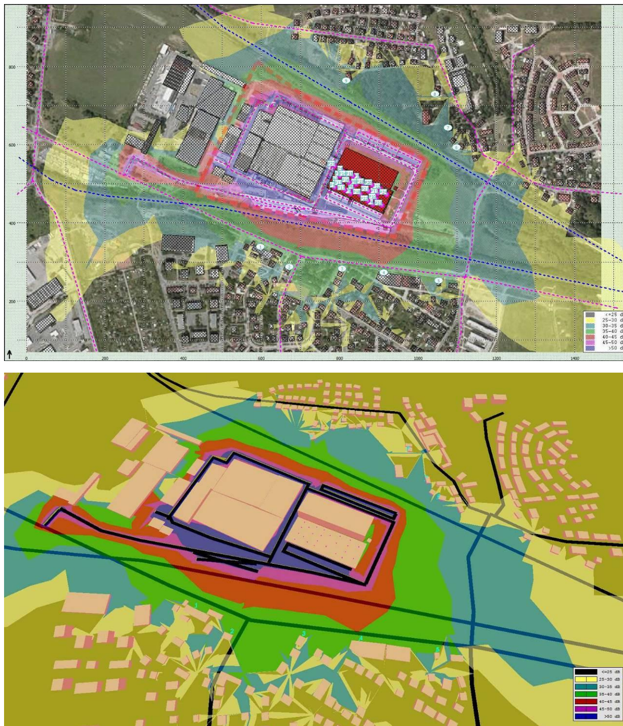
Obr. 11: Grafické znázornění výpočtového modelu - provoz záměru NOC - znázornění pásem izofon 1
