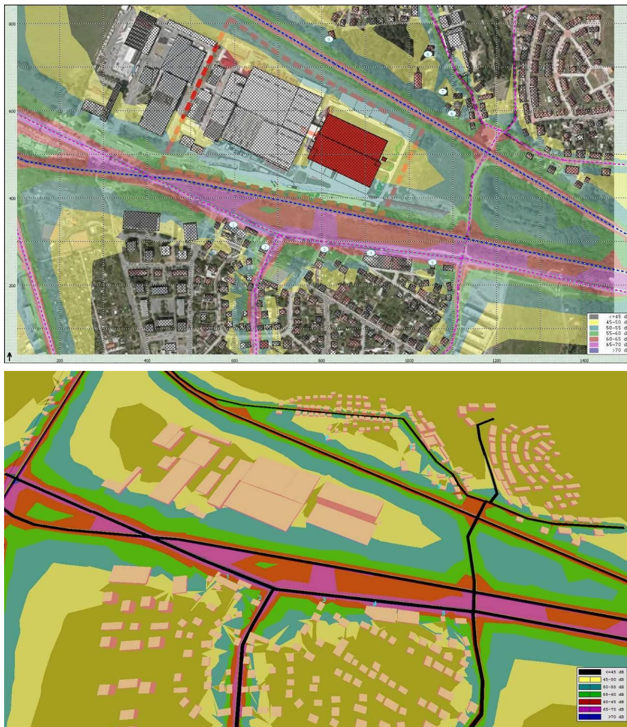
Obr. 8: Grafické znázornění výpočtového modelu – výhledová doprava na pozemních komunikacích DEN - znázornění pásem izofon 1
