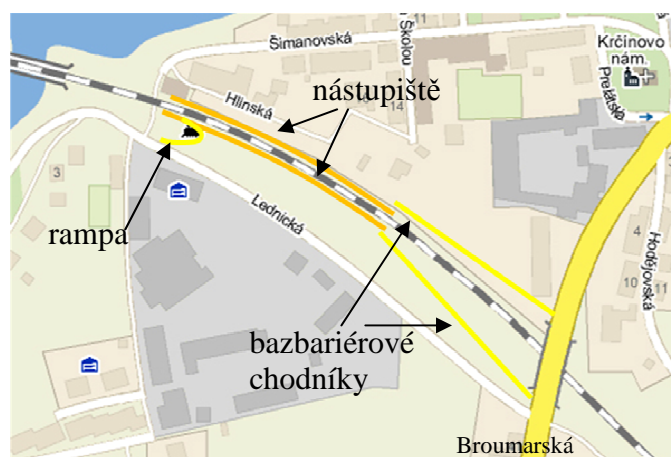
Obr. 22 - schéma bezbariérového přístupu na nástupiště z Broumarské a Lednické ulice
