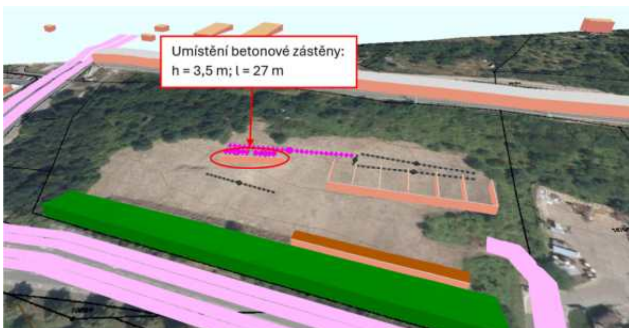
Obrázek 12 3D zobrazení umístění betonové zástěny v oblasti mobilního drtiče a třídičky
